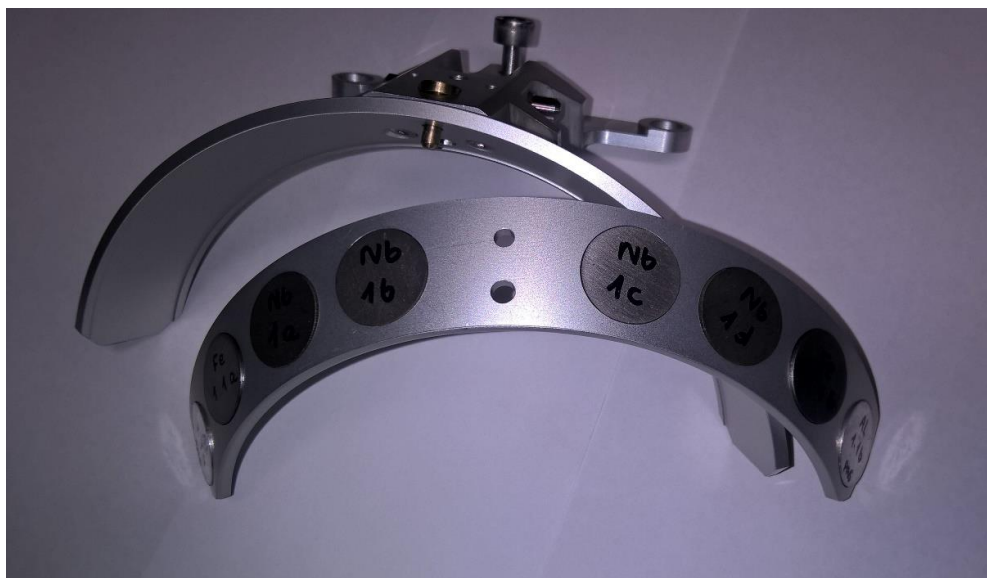
Rys. 51. Widok uchwytu wraz z zamocowanymi próbkami aktywacyjnymi.
