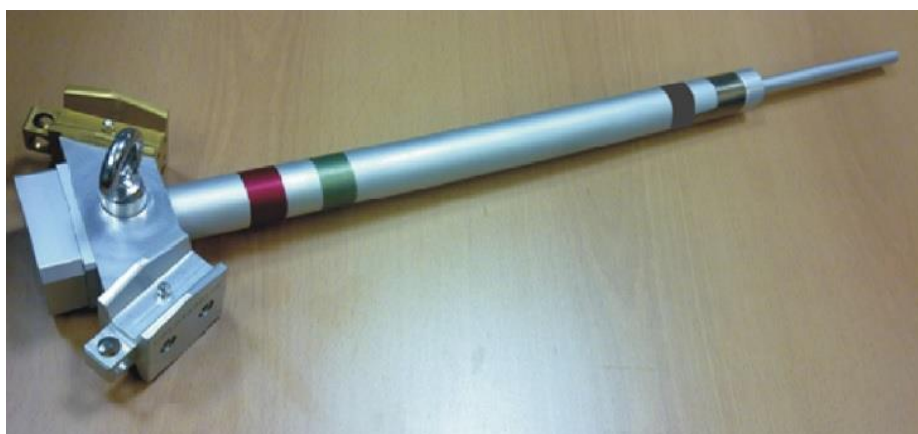
Rys. 11. Narzędzie umożliwiające pozycjonowanie źródła neutronów w tokamaku JET [18].
