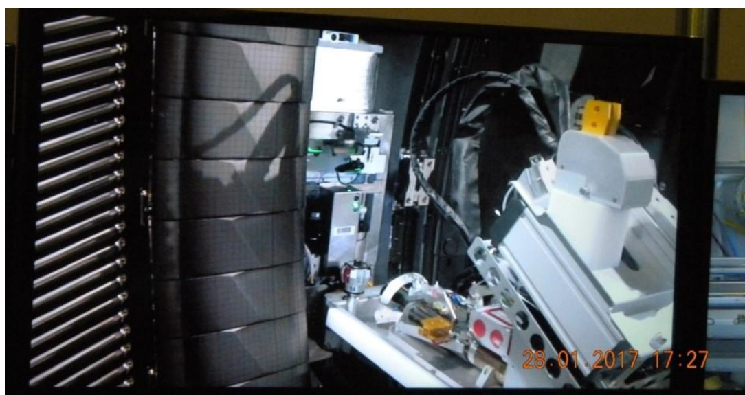
Rys. 71. Widok generatora neutronów umieszczanego wewnątrz komory próżniowej tokamaka JET.
