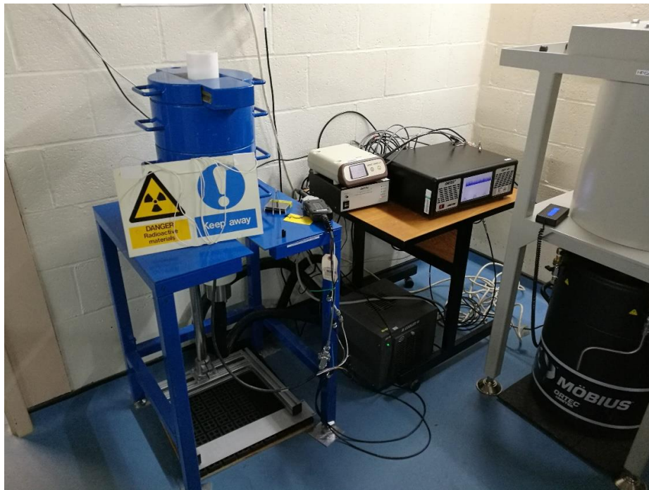
Rys. 73. Widok układu z detektorem półprzewodnikowym produkcji ORTEC, umieszczonym w osłonie ołowianej, który używano do pomiarów radioaktywności próbek podczas kampanii kalibracyjnej.
