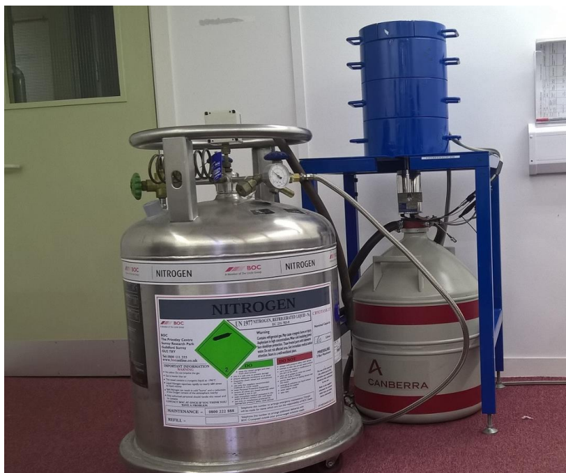
Rys. 29. Widok zastosowanego detektora HPGe firmy Canberra, który umieszczono wewnątrz odpowiedniej osłony.
