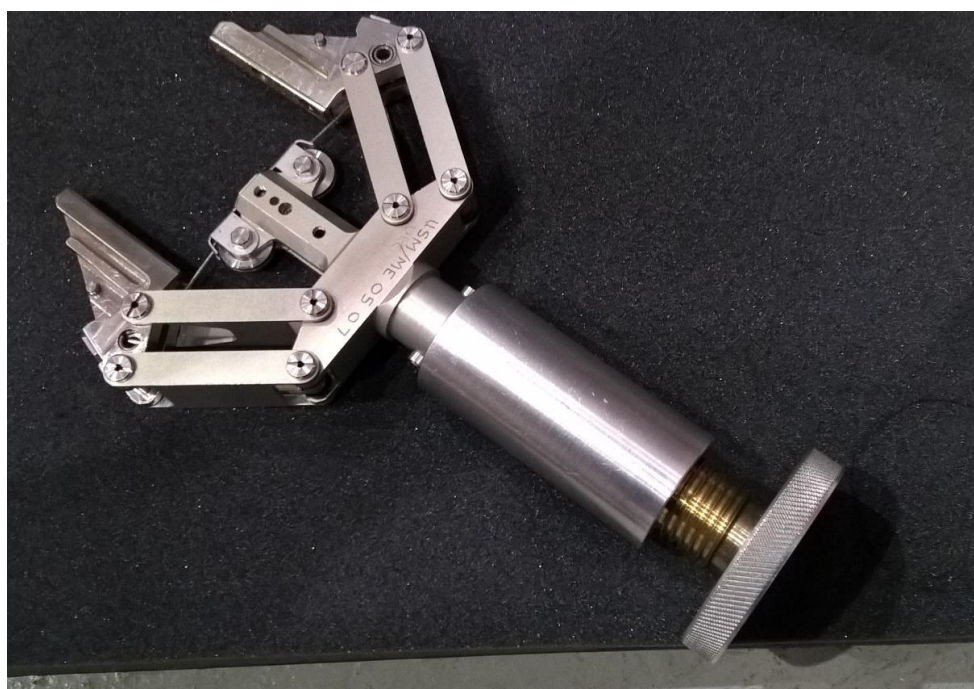
Rys. 52. Narzędzie służące do zdalnego montażu/demontażu uchwytu aluminiowego na generatorze neutronów.
