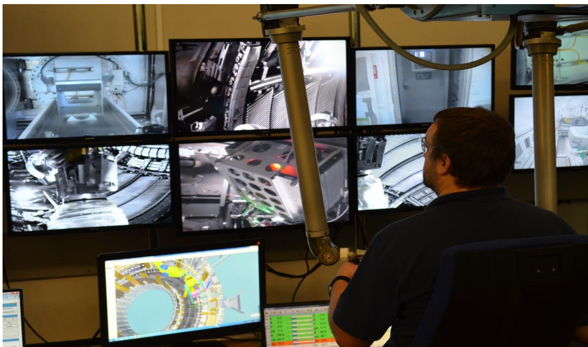
Rys. 72. System zdalnego sterowania, który umożliwił umieszczenie generatora neutronów wraz z monitorami neutronów w ściśle określonym położeniu wewnątrz komory próżniowej tokamaka JET w sposób powtarzalny.
