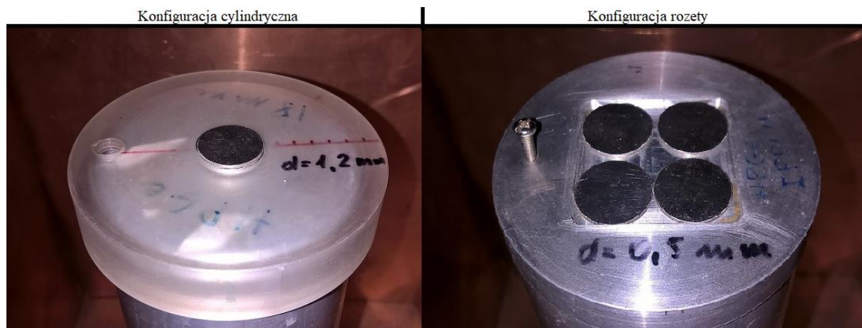
Rys. 31. Geometrie pomiarowe stosowane do oznaczania aktywności produktów reakcji jądrowych.
